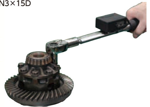
「CSPFHW100N3×15D」 + 「QH15D-3/8」 を使用した締付け作業例
