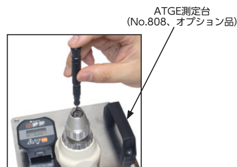
ATGEを使用したAMRD測定例
