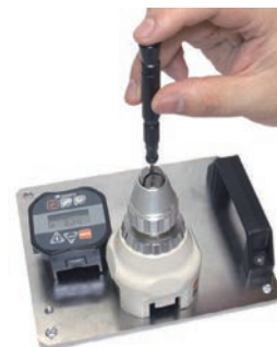
微小トルクドライバ AMRD の ATGE によるトルクチェック例 (オプションの ATGE 測定台を使用)
