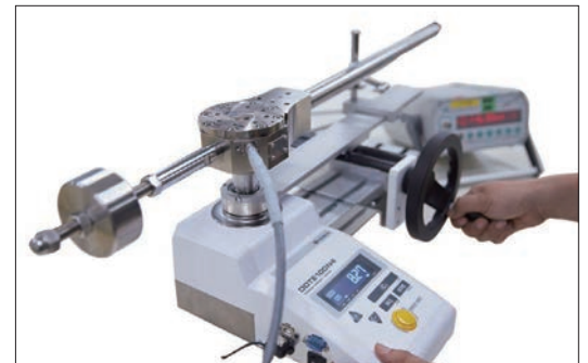
トルクレンチテスタ DOTE4 における JCSS 校正の例
