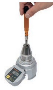
微小トルクドライバ BMRD の BTGE による トルクチェック例
