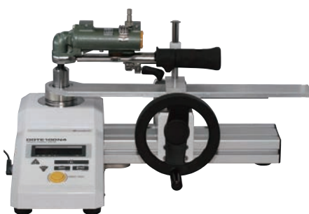
半自動エアトルク AC3 型 (左)、半自動電動トルクレンチ DAC3 型 (右) のトルクレンチテスト DOTE4 型による校正例
