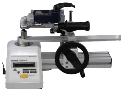
半自動エアトルク AC3 型 (左)、半自動電動トルクレンチ DAC3 型 (右) のトルクレンチテスト DOTE4 型による校正例
