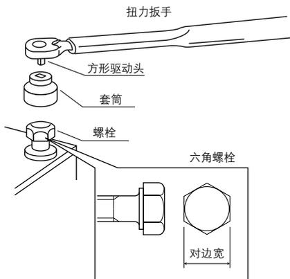
用扭力扳手紧固螺栓时，先将套筒嵌入头部的方形驱动头，然后紧固螺栓。套筒根据所紧固螺栓的对边宽及所用扭力扳手的方形驱动头的尺寸确定。
