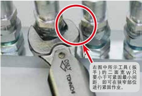
右图中所示工具(扳手)的侧面宽 W 只要小于可紧固最小间距, 即可在狭窄部位进行紧固作业。
